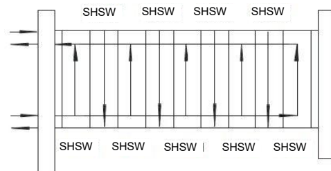
Figura 15: Circuito único com forma de canal (S) composto por placas com relevo diferente (H + W)
